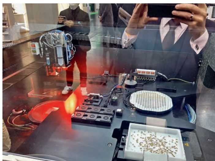
Монтаж кристаллов с ленты на рамке и элементов сборки из вибробункера на пластину
