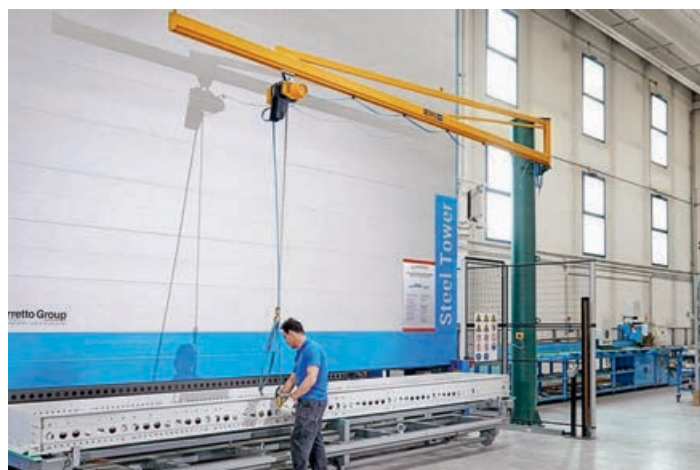
5 Поворотная кран-балка для работы с заготовками на полке
