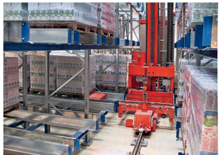
1 1 Палетная автоматизированная система с глубиной в несколько рядов в версии с краном-штабелёром.
